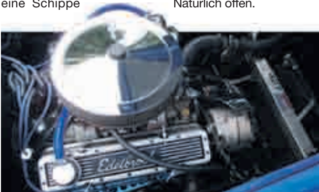
Kraftpaket: der 5,7 Liter V8 von Chevrolet mit Edelbrock-Zylinderköpfen.
