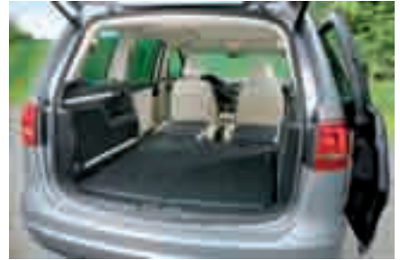
Dank EasyFold lassen sich die Sitze der zweiten Reihe einfach im Fahrzeugboden versenken.
