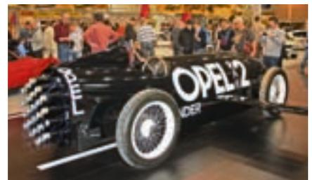
Opel feierte sein 150-jähriges Bestehen mit einigen Highlights der Modellgeschichte: dieser mit 24 Feststoffraketen bestückte Bolide erreichte 1928 eine Höchstgeschwindigkeit von 238 km/h, die 100 km/h erreichte Fahrer Fritz von Opel in für damalige Verhältnisse schwindelerregenden 8 Sekunden.
