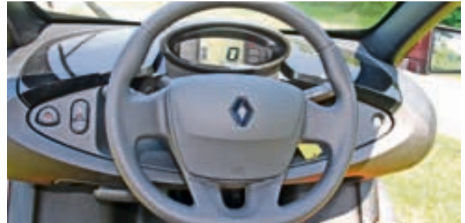
Sehr übersichtlich: das Cockpit mit Kombi-Display und den Schaltern für die Automatik (links).
