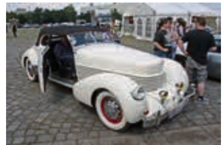
Cord 810 Phaeton von 1936 mit elektropneumatischem Vorwahlgetriebe.
