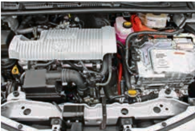
Vereint unter der Fronthaube: der Benziner (links) und der Elektromotor (rechts) haben eine Systemleistung von zusammen 100 PS.
