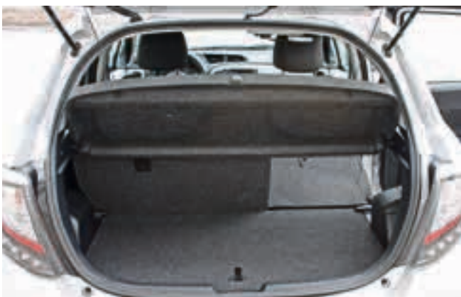
Weil der Akku platzsparend unter der Rückbank verstaut wurde, hat der Yaris Hybrid das gleiche Platzangebot wie der normale Yaris. Das Kofferraumvolumen beträgt 286 bis 768 Liter.
