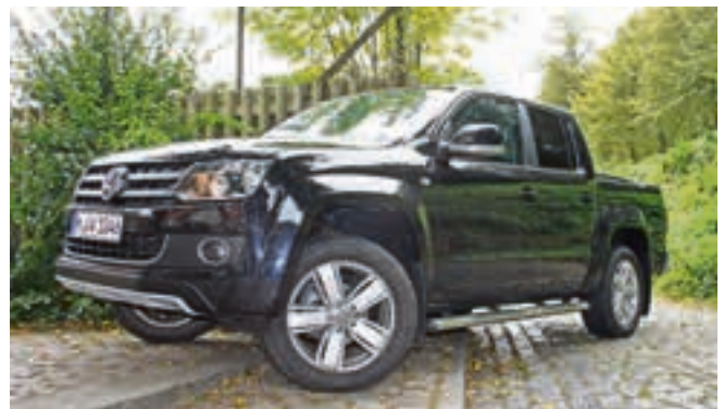
Der Amarok kommt dank Allradantrieb, zusätzlicher Unterstufenstufe und Differenzialsperre auch da hin, wo keine Straßen sind.
