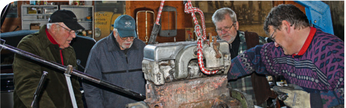
Mit vereinten Kräften: Klaus Thon, Adolf Eberl, Reinhard Koch und Horst-Dieter Görg setzen den Motor-Dummy in das bereits rekonstruierte Fahrgestell des Rekordwagens.
