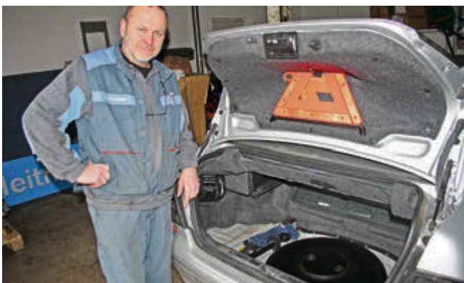
Andreas Heitmann zeigt, wie der Tank einer Autogasanlage in der Reserveradmulde untergebracht wurde - ohne Beeinträchtigung des Kofferraumvolumens, sogar in einem Cabrio.
