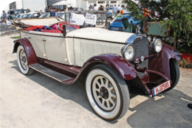
Eine echte Rarität: dieses Viertürige Cabrio von 1927 ist das erste Auto, das Daimler und Benz in Stuttgart gemeinsam bauten. Der 2-Liter 6-Zylinder leistet ganze 38 PS.
