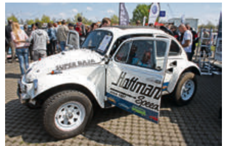
Entwickelt für den Einsatz bei der Rallye Dakar: Der Baja auf Käfer-Basis mit 200 PS Porsche-Motor und Allradantrieb.
