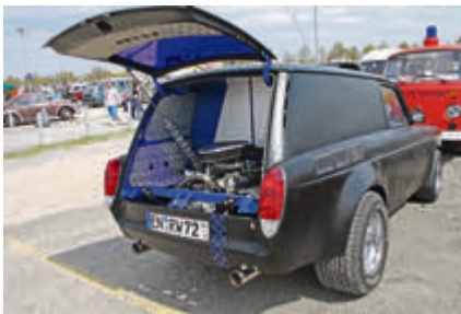
Untypischer Gast: 1600er Typ 3 mit 150 PS-Granada-Aggregat, 295er-Walzen – und Wasserkühlung.
