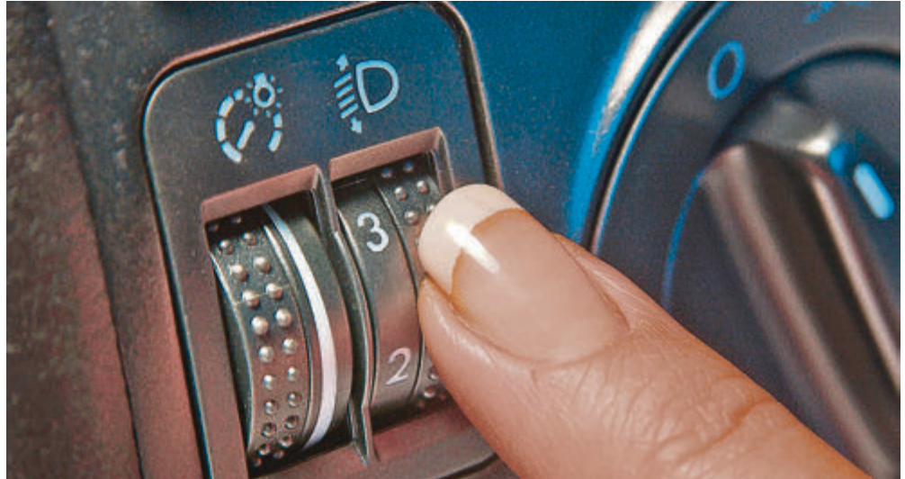
Kleines Rädchen, große Wirkung: Die Leuchtweitenregulierung.
