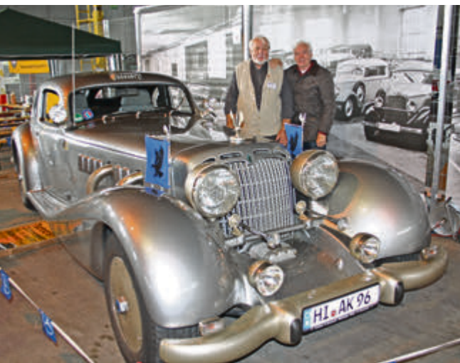
„Mit der Kraft der zwei Herzen“: Unter der schier endlos langen Haube des Isdera 116i Autobahnkurier arbeiten zwei Mercedes 8-Zylinder mit insgesamt 10 Litern Hubraum und 600 PS. Bernd Maschke vom Mercedes-Benz Veteranen Club war stolz, den Wagen samt Schöpfer Eberhard Schulz auf der Technorama begrüßen zu können.
