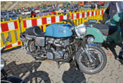
Fordert einen versierten Piloten: Münch 4 mit Vierzylinder-PKW-Motor aus dem NSU Prinz.
