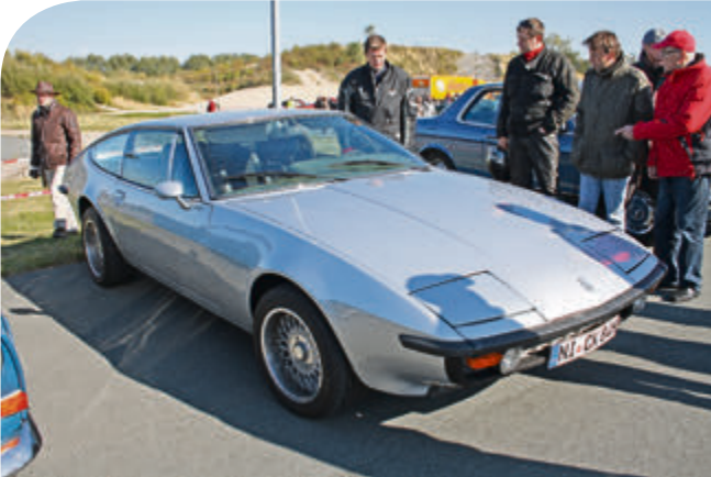
Sieht aus wie ein Maserati, ist aber ein Bitter CD, ein Fließheck-Coupé auf Basis des Opel Diplomat B mit V8 und 230 PS.
