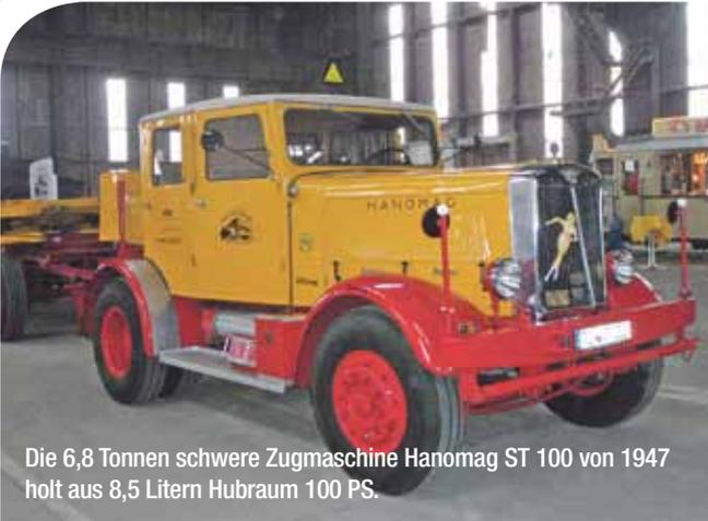
Die 6,8 Tonnen schwere Zugmaschine Hanomag ST 100 von 1947 holt aus 8,5 Litern Hubraum 100 PS.
