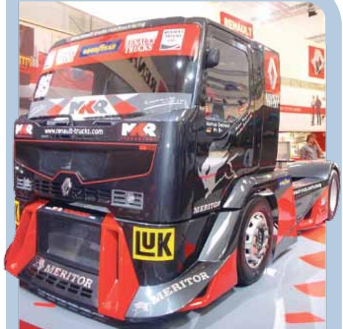
Formel 1 für LKW: Beim Truckracing startet dieser Renault mit gigantischen 1.110 PS aus 13 Litern Hubraum und einem unvorstellbaren Drehmoment von 5.100 Nm. Die Höchstgeschwindigkeit ist auf 160 km/h begrenzt.
