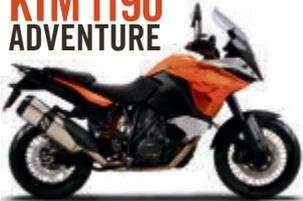
150 PS (110 kW), 230 kg inkl. 23 Liter Sprit, ABS, Traktionskontrolle, 15.000 km Inspektionsintervall, umfangreichste Technik- und Sicherheitspakete und ab Modelljahr 2014 serienmäßig mit MSC (Motorcycle Stability Control, 2013er- Modelle sind nachrüstbar).
