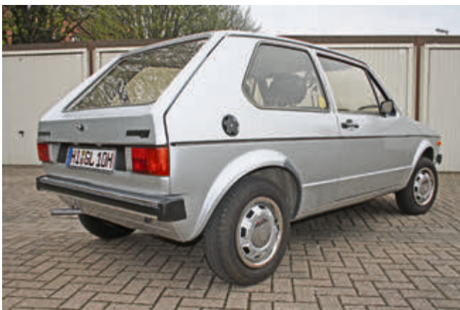
Dieser Golf ist eines der letzten Modelle mit den filigraneren Chrom-Stoßstangen, kurze Zeit später wurden die Kunststoffstoßfänger eingeführt.
