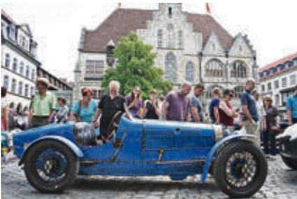
Rarer Racer mit außenliegendem Schalthebel: Bugatti Type 35.
