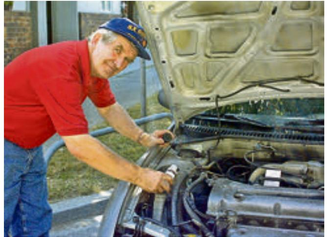
Richard Chambers beim Einfüllen von LecWec. Damit das Mittel wirkt, muss das Öl in Bewegung sein. Der Fahrzeugbesitzer muss nach dem Einfüllen mit dem Auto fahren.
