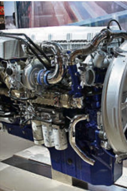
Kraftpaket: Dieser Volvo-Motor holt aus 16,1 Litern Hubraum bis zu 750 PS und satte 3.550 Nm Drehmoment.
