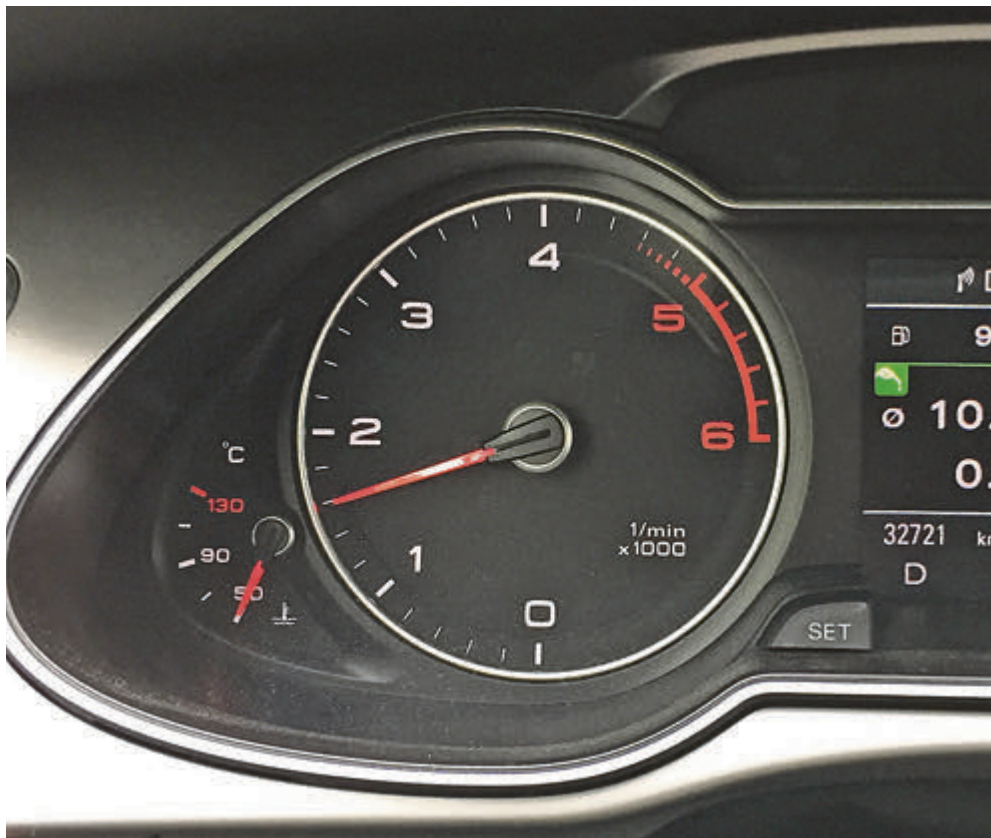
Der Drehzahlmesser eines Diesels: dank hohem Drehmoment hat der schon im niedrigen Drehzahlbereich ordentlich Power.
