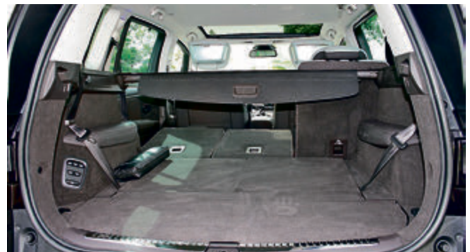
Die Sitze lassen sich über die Knöpfe links im Bild sowie über den Touchscreen automatisch umlegen. So kann das Ladevolumen von 247 Litern (bei 7 Sitzplätzen) bis zu 2035 Litern (2 Sitzplätze) variieren.
