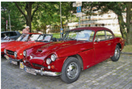
Karosserie aus glasfaserverstärktem Kunststoff und großvolumiger V8-Motor von Chrysler: der britische Jensen C-V8 MK III.
