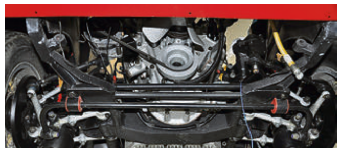
Eintauchen der Antriebseinheit in den komplett restaurierten Ferrari 330 GT von 1964. Solche Komplettrestaurationen beziehen auch eine Motor- und Getrieberevision mit ein. Besondere Sorgfalt muss geübt werden, wenn das Aggregat wieder im Bauch des Edel-Sportlers verschwindet!
