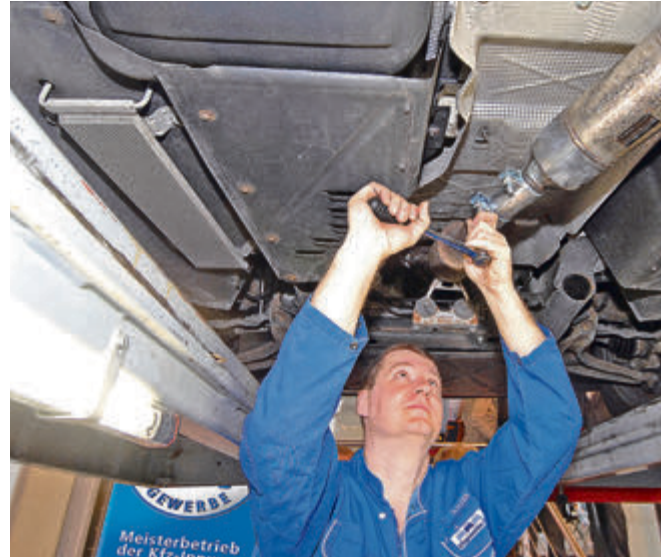
Die Nachrüstung von Dieselpartikelfiltern wird 2015 von der Bundesregierung mit 260 Euro pro Fahrzeug gefördert. Foto: ProMotor
