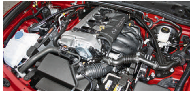
Ohne Plastikabdeckung: der fidele 2-Liter-Sauger mit 160 PS und 200 Nm Drehmoment.
