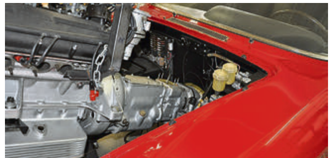
Eintauchen der Antriebseinheit in den komplett restaurierten Ferrari 330 GT von 1964. Solche Komplettrestaurationen beziehen auch eine Motor- und Getrieberevision mit ein. Besondere Sorgfalt muss geübt werden, wenn das Aggregat wieder im Bauch des Edel-Sportlers verschwindet!
