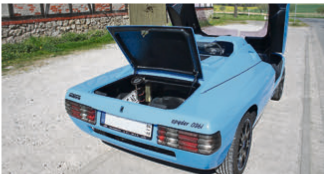
An den Heckleuchten sieht man, dass einige Teile des spyder aus dem Mercedes-Regal stammen. Dank Mittelmotor gibt es sogar einen brauchbaren Kofferraum.
