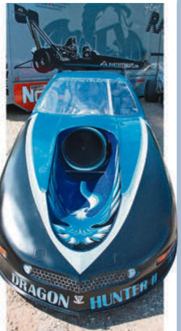
Hammer: Dieser Dragster wurde um eine 15.000 PS starke Turbine herum gebaut. Und weil das ganze Geschoss keine 700 Kilo wiegt, beschleunigt es auch in 5,9 Sekunden – auf 480 km/h!
