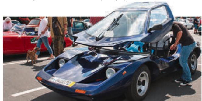
Kuriosität mit abgefahrener „Tür“-Lösung: bei diesem Sterling Nova mit Käfer-Fahrgestell und GFK-Karosserie öffnet sich das komplette Dach + Frontscheibe zum Ein- und Aussteigen.
