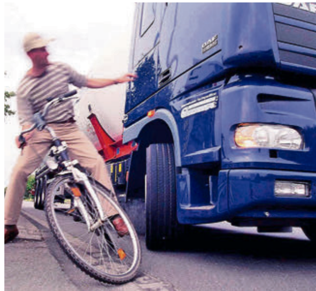
Selbst die inzwischen häufig verbauten Rund-um-Spiegelsysteme an Lkw helfen nicht zu 100 Prozent gegen den gefürchteten „Toten Winkel“. Wirksame Abhilfe schaffen elektronische Überwachungssysteme. Zubehörspezialist WAECO präsentiert jetzt mit dem MagicWatch MWE 4004 solch ein Assistenzsystem zum einfachen Nachrüsten. Insgesamt vier Sensoren scannen beim Abbiegevorgang den kritischen Toten Winkel und die Beifahrerseite des Nutzfahrzeugs und warnen den Fahrer visuell über das 4-Farb-LED-Display im Cockpit und akustisch über einen deutlich wahrnehmbaren Piepton aus dem Lautsprecher. Preis 369,-Euro, Infos unter www.dometic.de
