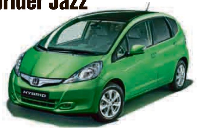
ination aus 1.3 Liter i-VTEC-Verbrennungsmotor (88 PS) und einem Elektromotor (zusätzliche 14 PS). Wie beim Insight erfolgt die Kraftübertragung auch beim Jazz Hybrid über ein CVT-Getriebe. Die Höchstgeschwindigkeit liegt bei 177 km/h.
