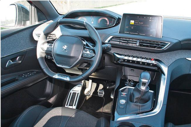
Schick, hochmodern und mit Premiumanmutung: das Interieur mit digitalem i-Cockpit, 8-Zoll-Touchscreen und den „Toggle Switches“-Kippschaltern in der Mittelkonsole.
