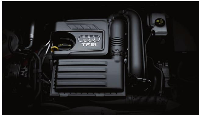
Audi nutzt bei einigen seiner TFSI Motoren das System cylinder on demand (COD): Es legt im Teillastbereich vier beziehungsweise zwei Zylinder still.
