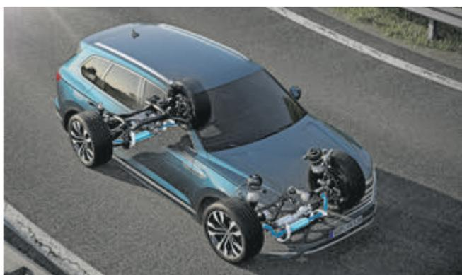
Drehstab-Stabilisator in modern: die elektromechanische Wankstabilisierung des neuen VW Touareg. Dabei passen sich die aktiven Stabilisatoren mittels E-Motoren und einem 48-Volt-System blitzschnell der Fahrsituation an. Foto: Volkswagen
