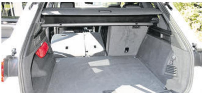
Die Rücksitzlehnen lassen sich vom Kofferraum aus umlegen und erhöhen so das Ladevolumen von 810 auf 1800 Liter. Dank Luftfederung kann man das Heck zum besseren Beladen absenken.
