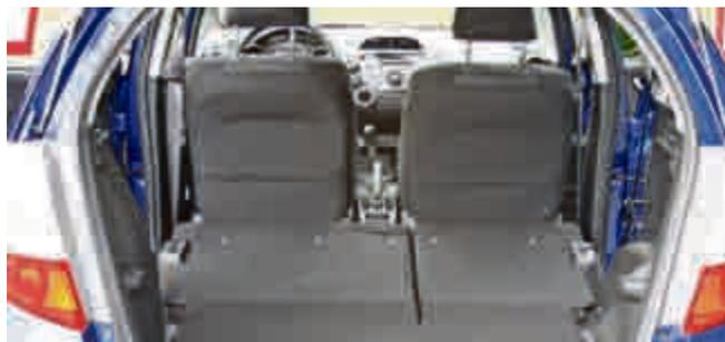
Nach Umklappen der Rücksitzlehnen entsteht eine ebene Ladefläche mit einem Volumen von bis zu 1384 Litern.
