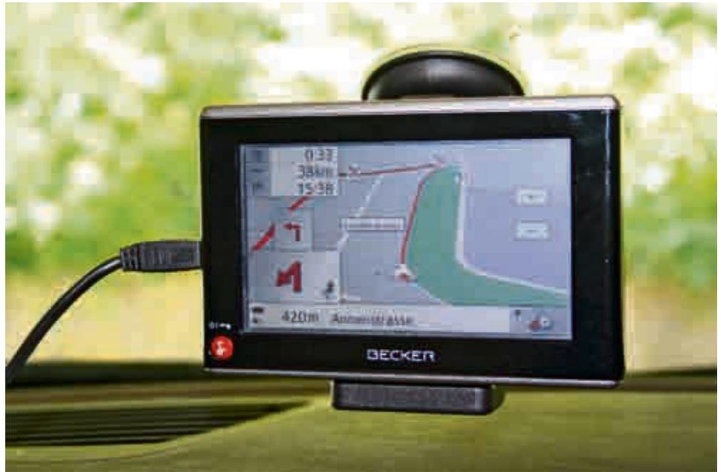
gnalreise ergibt Abstand zum Satelliten). Die Signale eines zweiten Satelliten ergeben rechnerisch die genaue Position auf einer Kreisbahn, die eines dritten die punktgenaue Position. Theoretisch. Praktisch gibt es bei all dem so viele Signal- und Rechenfehler, dass erst mit jedem weiteren Satellitensignal eine immer genauere Positionsbestimmung und im weiteren sogar eine brauchbare Geschwindigkeitsberechnung durchführbar ist.
