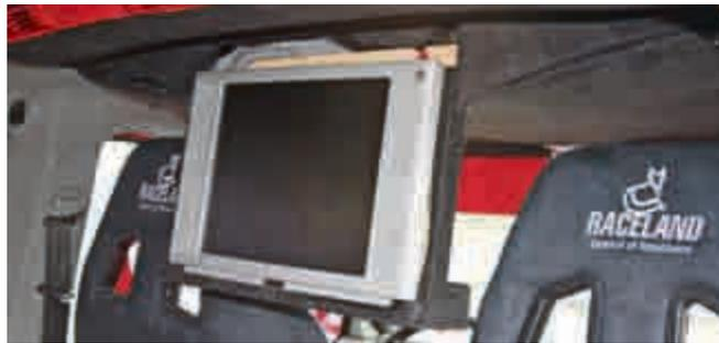
Mit Hilfe eines Fensterhebermotors aus dem R5 verschwindet der Monitor im Dachhimmel.
