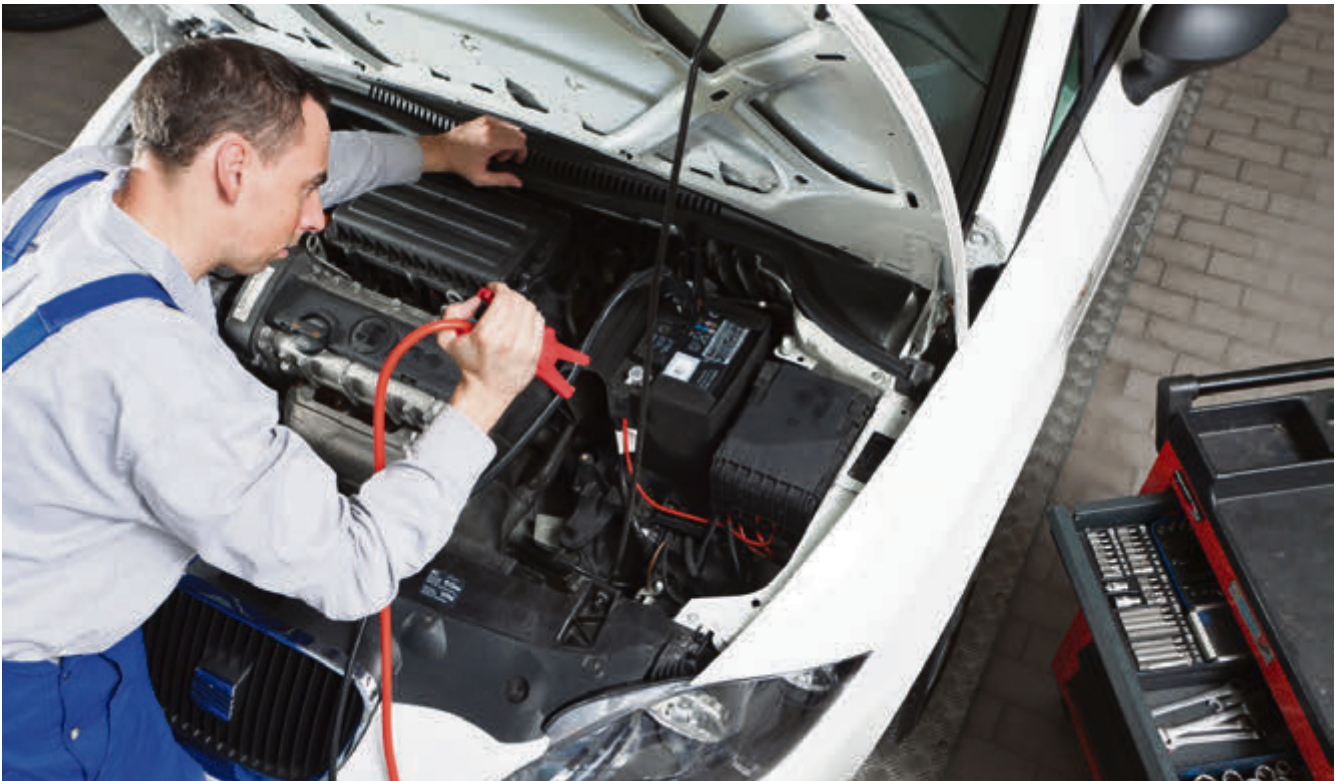
Hoch-Zeit für Batterien: Wer in der kalten Jahreszeit mobil bleiben möchte, lässt den Lade- und Säurezustand des Akkus in der Werkstatt testen. Foto: ProMotor/Timo Volz.
