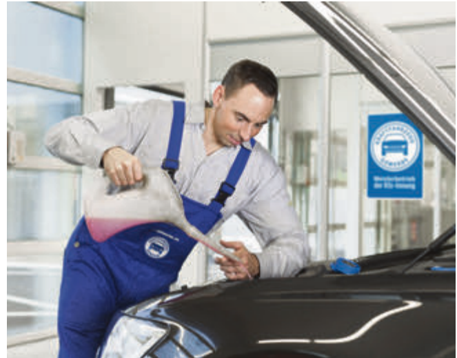
Um teure Motorschäden zu vermeiden, ist regelmäßige Kontrolle des Kühlmittelstands ratsam. Foto: ProMotor/ T. Volz
