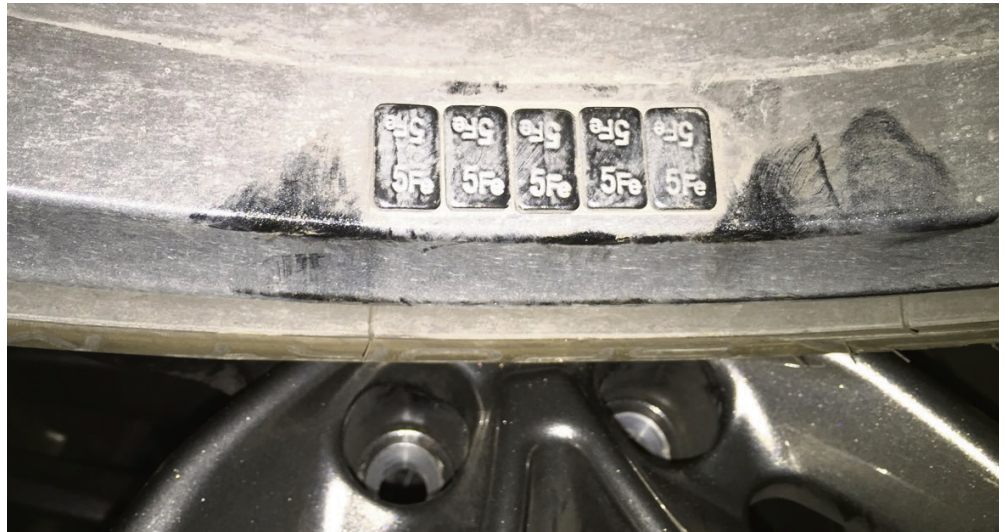
Damit's rund läuft: Diese kleinen Gewichte im Felgeninneren „bekämpfen“ die Unwucht.
