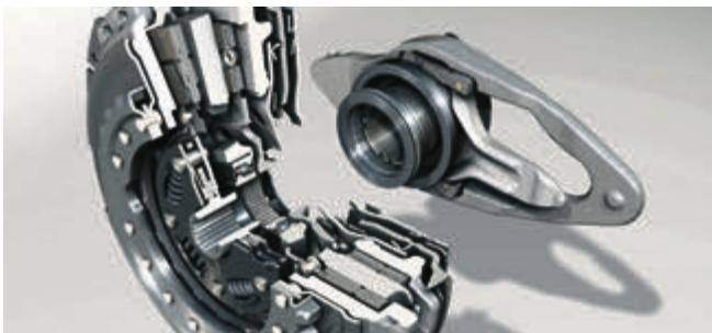
Kuppeln ist nicht Jedermanns Sache, gut dass es Lösungen wie ein Doppelkupplungsgetriebe gibt. Foto: Volkswagen
