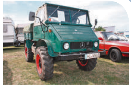
32 PS, Höchstgeschwindigkeit 53 km/h: Unimog U411 Cabrio von 1961.
