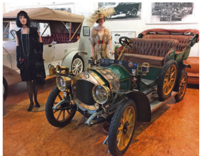
Ein frühes Colibri-Modell von 1908 mit 8 PS-2-Zylinder. Eine technische Besonderheit der Norddeutschen Automobil Werke war der Einbau eines Vorläufers der Startautomatik mit Hilfe einer Bi-Metall-Feder am Vergaser.
