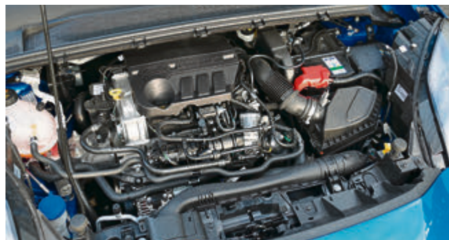
Kleines Kraftpaket: Der 1-Liter 3-Zylinder Turbobenziner mit moderner 48-Volt-Mild-Hybrid-Technologie leistet 155 PS.
