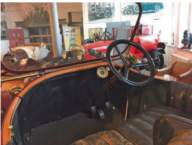
Spartanisches Cockpit eines Sperber. Bis in die 20er Jahre waren auch die deutschen Autos Rechtslenker, da damals die Gefahr noch vom Straßenrand ausging. Mit zunehmenden Gegenverkehr wurde dann auf Linkslenkung umgestellt.
