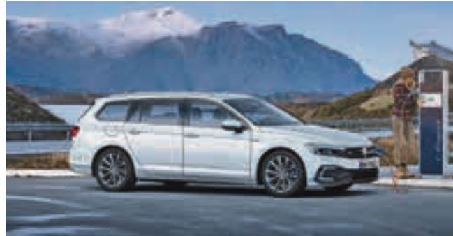
Der Passat GTE Variant mit Plug-In-Hybridantrieb (Turbobenziner (TSI) und Elektromotor). Er kann bis zu 56 Kilometer lokal emissionsfrei im E-Mode gefahren werden.
