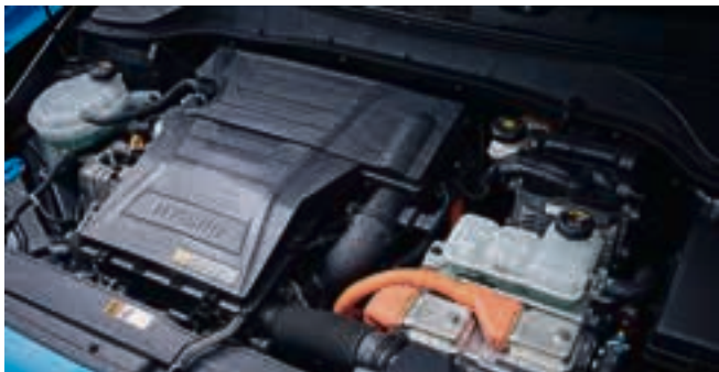
Hybridantrieb: Beim Fahren merkt man nichts, die Steuerelektronik regelt den Einsatz des kleinen E-Motors so, dass die Kraftstoffeffizienz optimiert wird.
