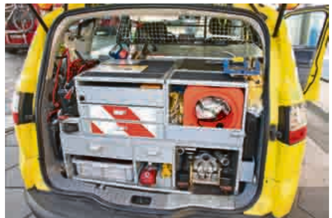
Wo in einem normalen Ford S-Max die Rücksitze sind, befinden sich beim Pannenhelfer Schubladen und Kisten mit Werkzeug und Ersatzteilen.
