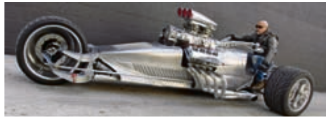
Der Name ist Programm: Das Hemi-Trike-Rocket II geht ab wie eine Rakete. Das Trike, fünf Meter lang, 1225 Kilogramm schwer, erreicht eine Höchstgeschwindigkeit von 320 km/h. Angetrieben wird es von einem Hemi V8-Siebenliter-Motor. Insgesamt liegen 1200 PS unter der Haube.
