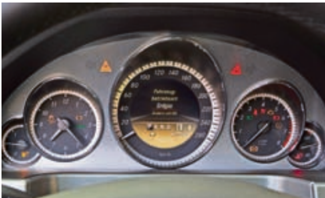
Im Tachodisplay wird angezeigt, in welcher Betriebsart (Benzin oder Erdgas) der Mercedes gerade fährt.
