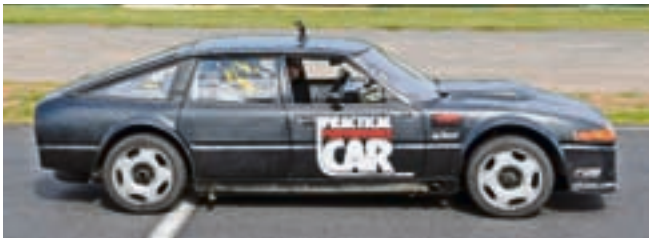
1981er Rover SD-1 mit 27 Liter Rolls Royce Motor aus einem Kampffjet (12 Zylinder, 650 PS). Um die Kraft auf die Straße zu bringen, verbaute Besitzer Charlie Bromfield u.a. eine Hinterachse von einem Ford F150 Pickup und den Antriebsstrang von einem Leyland Omnibus.
