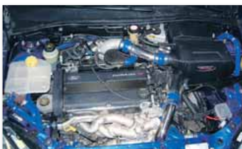
250 PS, 425 Nm Drehmoment: Der 2-Liter-Turbo
