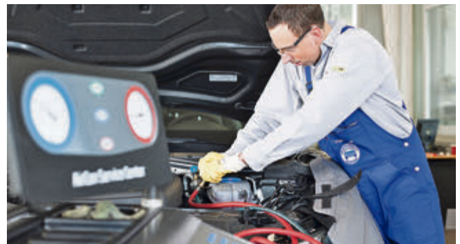
Ein Fachbetrieb sollte die Klimaanlage in regelmäßigen Abständen (etwa alle zwei Jahre) entleeren und neu befüllen sowie den Filtertrockner austauschen. Foto: ProMotor/T. Volz
