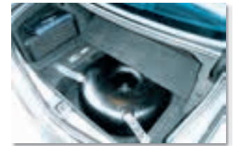
Der Autogas-Tank wird platzsparend in der Reserveradmulde untergebracht.
