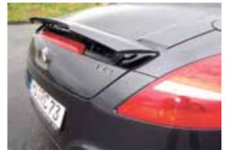
Der Heckspoiler fährt ab 85 km/h automatisch aus.
