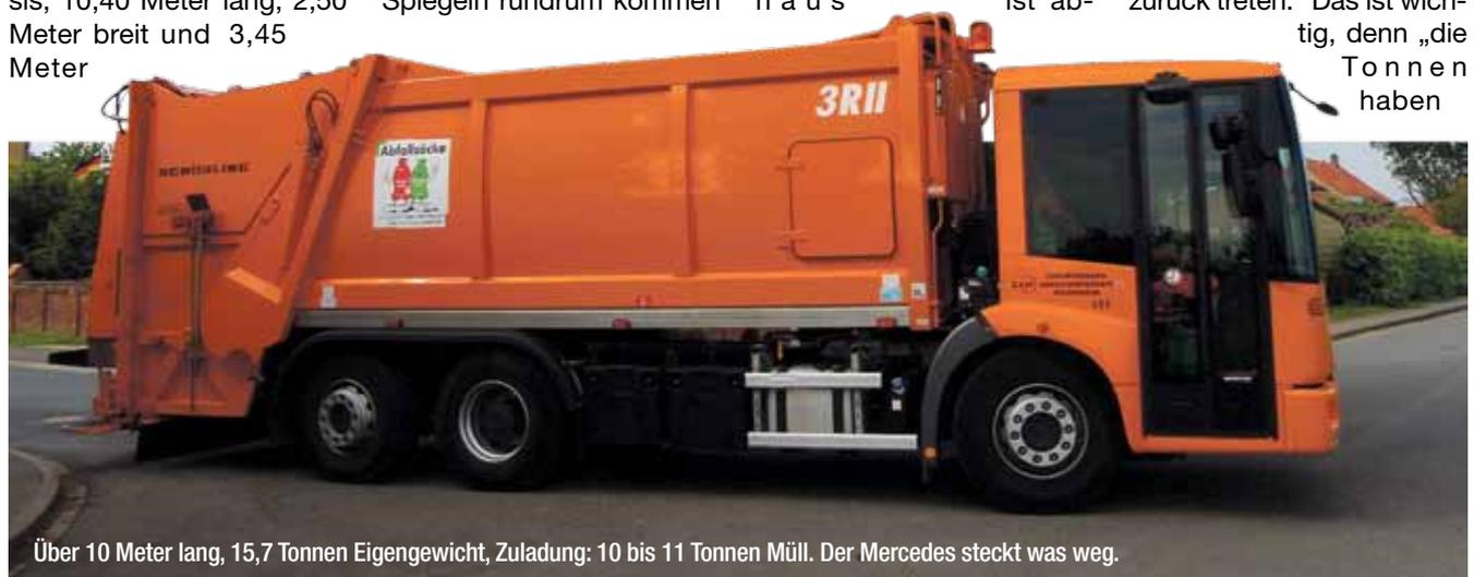
Über 10 Meter lang, 15,7 Tonnen Eigengewicht, Zuladung: 10 bis 11 Tonnen Müll. Der Mercedes steckt was weg.
