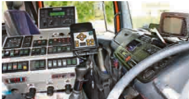
Kommandozone: Schaltputz für Kehrbetrieb und Winterdienst.
