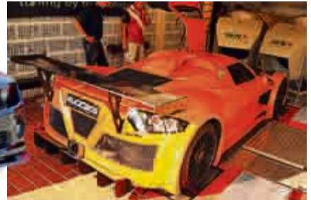
Tagessieger: Der Gumpert Apollo erreichte 800 PS auf dem SKN-Prüfstand.
