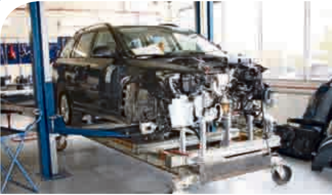
Arbeiten auf einer professionellen Richtbank.
