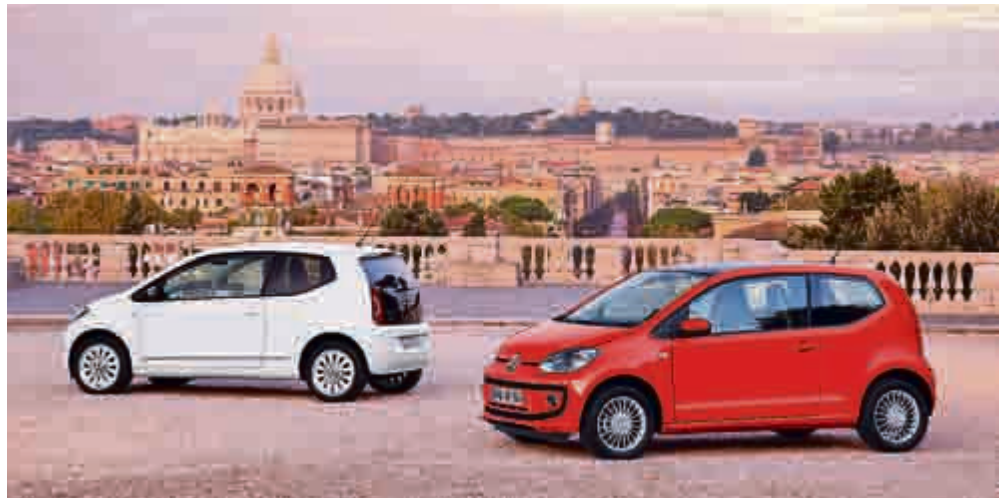
Auf nur 3,54 Metern Länge bietet der VW up! Platz für 4 bzw. ein Kofferraumvolumen von 251 bis 951 Liter.
