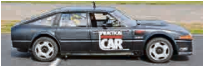
1981er Rover SD-1 mit 27 Liter Rolls Royce Motor aus einem Kampffjet (12 Zylinder, 650 PS). Um die Kraft auf die Straße zu bringen, verbaute Besitzer Charlie Bromfield u.a. eine Hinterachse von einem Ford F150 Pickup und den Antriebsstrang von einem Leyland Omnibus.
