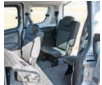
Praktisch 4: Hinter der garagentorgroßen Heckklappe verbirgt sich ein Laderaum von 133 l (bei 7 Sitzen) bis zu 3.200 l (bei umgeklappter Rückbank).
