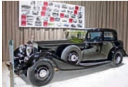
Der Rolls Royce Phantom II Continental wurde speziell für eine Klientel gebaut, die Wert auf hohe Reisegeschwindigkeiten legte. So erreichte dieses Modell mit 7,66-Liter 6-Zylinder eine Höchstgeschwindigkeit von 150 km/h – nicht schlecht für 1934.
