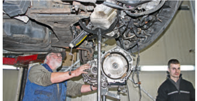
Horst Reimers und Talha Ciner bauen das instandgesetzte Getriebe wieder in den VW T4 ein.
