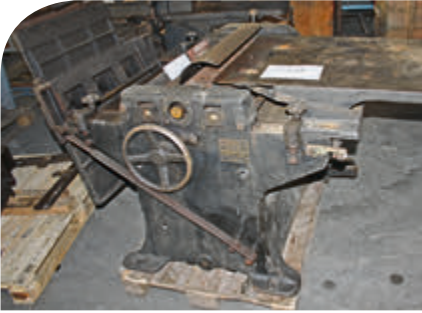
Wird später Bestandteil der nachgebauten Drechslerwerkstatt: eine kleine Abrichthobel- und Fügemaschine.
