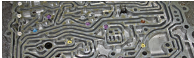
Das „Gehirn“ des Getriebes: Die Kanäle des Steuerblocks werden akribisch gereinigt.
