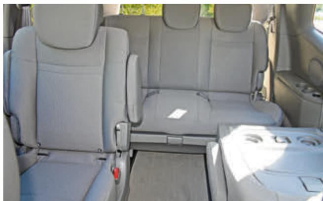
Hier wird Variabilität groß geschrieben: die Einzelsitze in Reihe zwei lassen sich verschieben und zu einem Tisch umklappen, die Rückbank ist ebenfalls längs verschiebbar.
