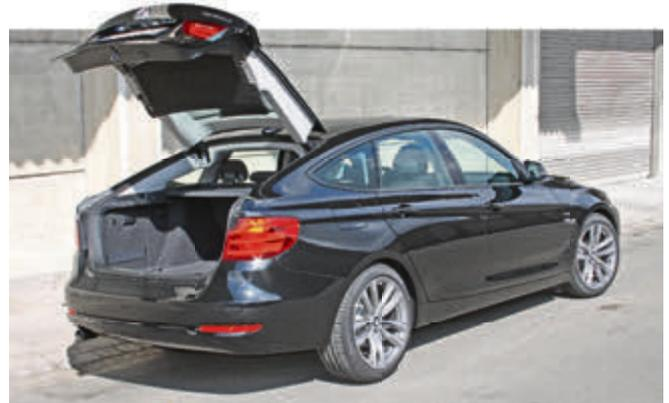
Die weit aufschwingende Heckklappe lässt sich automatisch betätigen und gibt einen Laderaum von 520 bis 1600 Liter Volumen frei.
