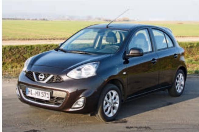
tion des Micra aktuell einem Facelift unterzogen. Die besagten Scheinwerfer schauen jetzt ausdrucksstärker in die Welt, der größere Kühlergrill mit V-förmiger Chromleiste wirkt edler und betont die Familienzugehörigkeit zum Juke und dem neuen Note. Auch die Nebelscheinwerfer sind jetzt in Chrom gefasst, die Stoßfänger vorne wie hinten neu geformt und die Rückleuchten mit moderner LED-Technik versehen. Insgesamt wirkt der neue Micra „echt knuffig“ (so was sagen Frauen tatsächlich zu einem Auto).
