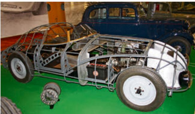
Der Wiederaufbau des Hanomag Weltrekordlers – ebenfalls mit Diesel unter der Stromlinienfront – schreitet voran.
