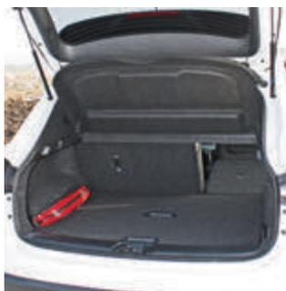
Der Kofferraum hat ein Volumen von 430 bis 1585 Liter bei umgeklappten Rücksitzlehnen. Dank doppeltem Ladeboden und herausnehmbaren Bodenplatten lassen sich bis zu 16 verschiedene Lademöglichkeiten konfigurieren.
