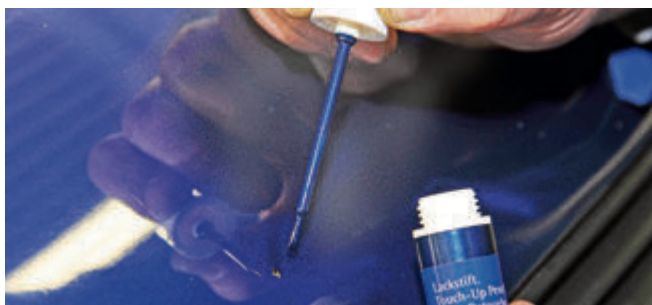
Nach der Wäsche kommen sie ans Licht: Split- und Steinschlagschäden auf Lack und Glas. Erste Hilfe vor Rost bieten Lackstifte. Foto: ProMotor
