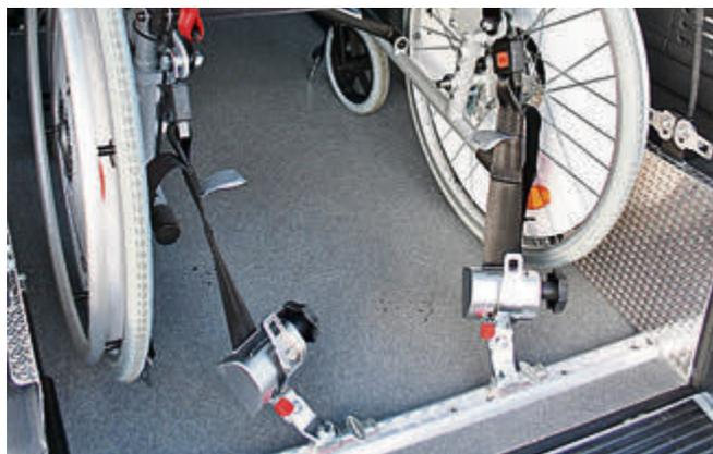
Mit Hilfe sogenannter Kraftknotenadapter wird der Rollstuhl sicher am Fahrzeugboden fixiert.
