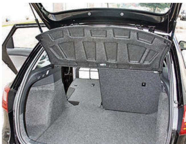
430 Liter fasst der großzügige Kofferraum im Normalzustand und kann nach Umliegen von Sitzfläche und Rücklehnen auf einen ebenen Laderaum mit bis zu 1164 Liter erweitert werden.
