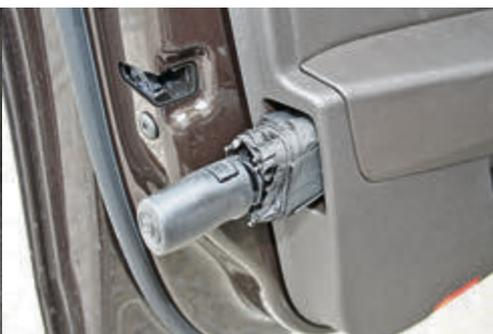
Insgesamt 29 „Simply Clever“-Lösungen gibt es im neuen Superb, darunter beliebtes wie die Schirme in den vorderen Türen und die als Taschenlampe herausnehmbare Kofferraumbeleuchtung.
