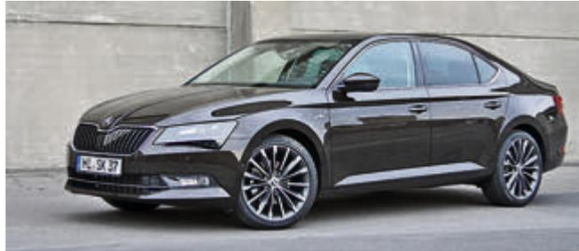
Leidenschaft.“ Der Radstand wuchs um 80 mm, gleichzeitig wurde der vordere Überhang um 61 mm verkürzt. Diese neue Architektur gibt dem Fahrzeug zusammen mit den präzisen Falzen und Lichtkanten sowie der sanft abfallenden, coupéartigen Dachlinie ein vornehm-elegantes Erscheinungsbild.
