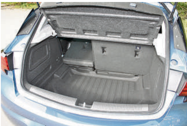
Das Gepäckabteil schluckt 370 Liter. Klappt man die asymmetrisch geteilten Rücksitzlehnen um, stehen bis zu 1210 Liter Ladevolumen zur Verfügung.
