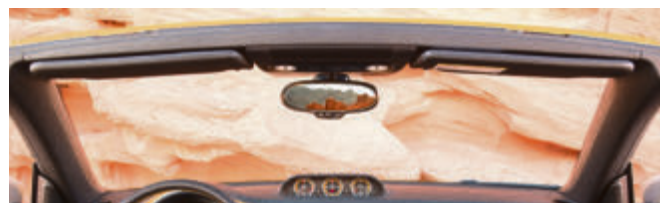
Die Windschutzscheibe moderner Autos ist aus Sicherheits-Verbundglas.
