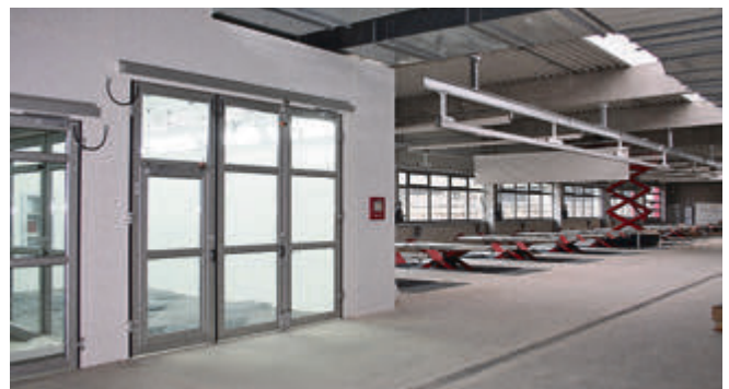
Der Bereich für die Vorarbeit mit 9 Multifunktionsarbeitsplätzen, die mittels elektrischer Vorhänge abgetrennt werden können. Im Vordergrund: eine Highend Füller- und Trocknerkabine der schwäbischen Firma Sehon.
